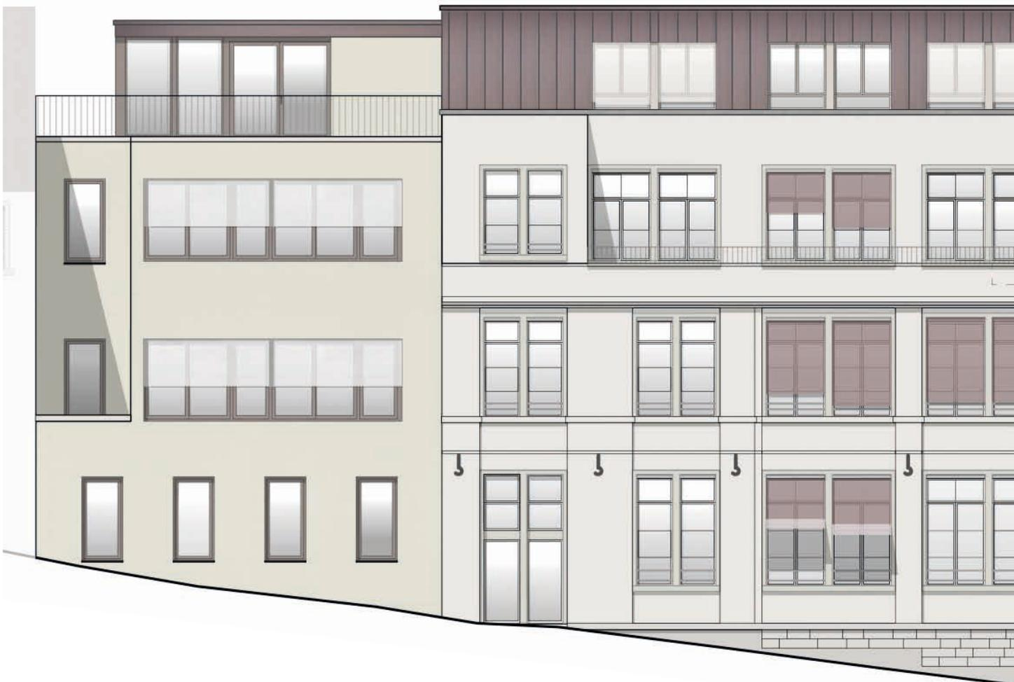
Der nördliche Anbau aus den 1990er Jahren wird energetisch und schalltechnisch ertüchtigt und einer optischen Aufwertung unterzogen. In hochwertiger Massivbauweise aus Beton und Backsteinmauerwerk entsteht der Neubau. Eine leistungsstarke Mineralwoll-dämmung schützt dabei das Gebäude umfassend vor Kälte und Hitze. Die Ziegeleindeckung der Steildächer mit Biberschwanzziegeln integriert die Überbauung in den städtebaulichen Kontext der Altstadt und bildet so Gemeinschaften mit den Nachbargebäuden.
